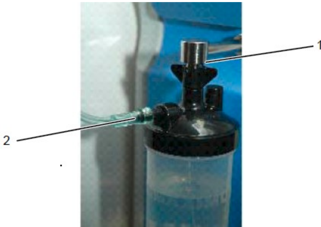
Фиг. 8- Сглобяване на овлажнителя
